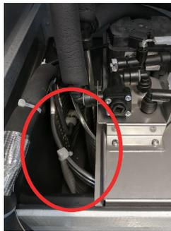
7. Insérer le tuyau d'évacuation (tuyau de vidange situé au dos de la fontaine).
